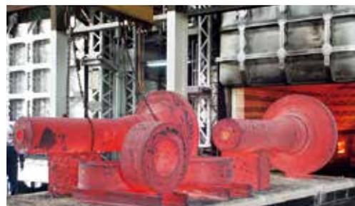
風力発電装置主軸の焼入作業（炉出し）
