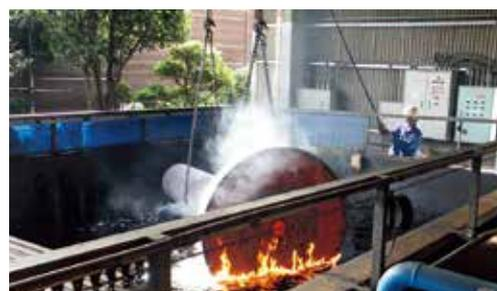
風力発電装置主軸の焼入作業（油冷）
