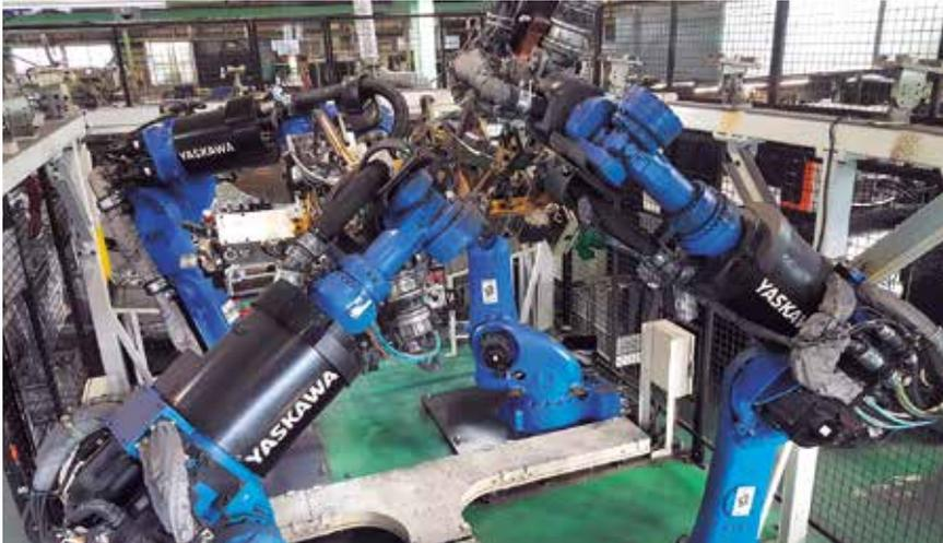
溶接ロボット4台をリンクさせた生産方法のセル生産システム
