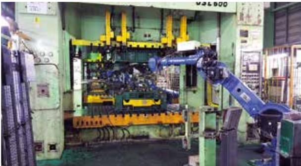
タンデムプレス間搬送もロボットで行う無人化プレス加工ライン
